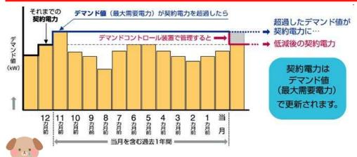
(例)デマンド監視装置なしで契約電力が10kw超過した場合 @1,472/kw月\*×10kw×12月/年=**176,640円**の支払い増になります。 \*業務用電力、力率割引15%の場合 左表のように、わずかひと月の電力使用量が契約電力を超えると、まるで<mark>罰ゲームのように</mark>1年間契約電力料金がアップします。 それを防ぐ為には
